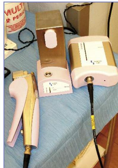
e di plasma. Tale apparecchiatura, portatile e dotata di un sistema di ricarica, dà una maggiore sicurezza alle operatrici sanitarie e può essere utilizzata direttamente presso il donatore evitando di portare al bancone la sacca prima che questa venga chiusa ermeticamente. Sostituisce la vecchia saldatrice da banco ormai obsoleta e non più utilizzabile con sicurezza.
